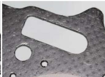
*Anillos de fuego unidos y reforzados, específicamente diseñados para evitar fugas de compresión.*
