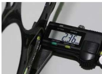
*Reducción del 30% en el grosor para ahorrar costos de material. Reduce la vida útil del motor.*
